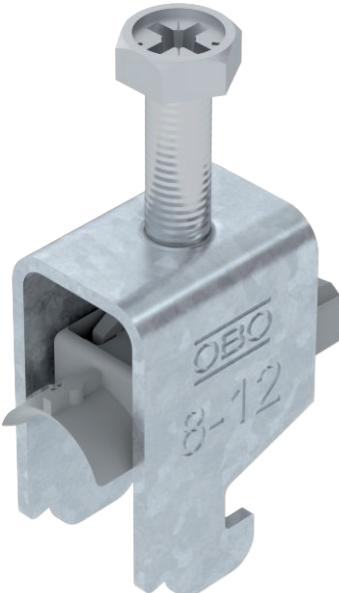
Bügelschelle mit N-Fuß, Kunststoffdruckwanne aus Polypropylen. Zur vertikalen und horizontalen Montage von 1 Einzelkabel an C-Proflschiene. Für Schlitzweite 11 - 12 mm. Mit 1-gängiger Schraube an Druckwanne, universeller Sechskant-Schraubenkopf SW10, mit Schlitz und Kreuzschlitz. Geeignet für Montage im Innen- und Außenbereich. Der Einsatz einer Gegenwanne wird empfohlen.
