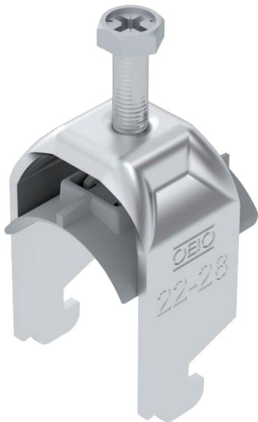
Bügel­schelle mit N-Fuß, Kunststoffdruckwanne aus Polypropylen. Zur vertikalen und horizontalen Montage von 1 Einzelkabel an C-Profilschiene. Für Schlitzweite 11 - 12 mm. Mit 1-gängiger Schraube an Druckwanne, universeller Sechskant-Schraubenkopf SW10, mit Schlitz und Kreuzschlitz. Geeignet für Montage im Innen- und Außenbereich. Der Einsatz einer Gegenwanne wird empfohlen.
