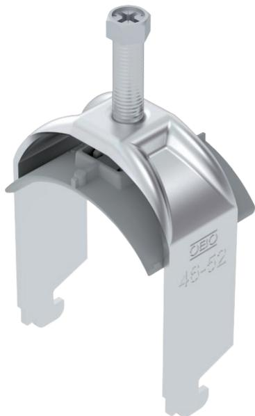
Bügelshelle mit N-Fuß, Kunststoffdruckwanne aus Polypropylen. Zur vertikalen und horizontalen Montage von 1 Einzelkabel an C-Profilschiene. Für Schlitzweite 11 - 12 mm. Mit 1-gängiger Schraube an Druckwanne, universeller Sechskant-Schraubenkopf SW10, mit Schlitz und Kreuzschlitz. Geeignet für Montage im Innen- und Außenbereich. Der Einsatz einer Gegenwanne wird empfohlen.
