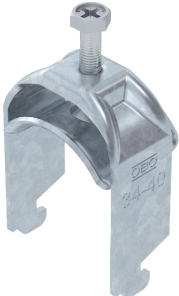
Bügelschelle mit N-Fuß, Metalldruckwanne mit gerundeten Kanten für Kabelschutz. Zur vertikalen und horizontalen Montage von 1 Einzelkabel an C-Proflschiene. Für Schlitzweite 11 - 12 mm. Mit 1-gängiger Schraube an Druckwanne, universeller Sechskant-Schraubenkopf SW10, mit Schlitz und Kreuzschlitz. Geeignet für Montage im Innen- und Außenbereich. Der Einsatz einer Gegenwanne wird empfohlen.
