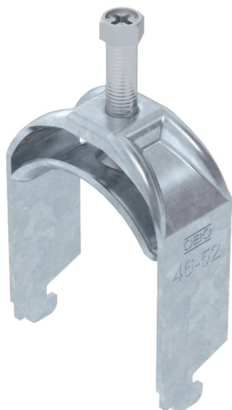
Bügelshelle mit N-Fuß, Metalldruckwanne mit gerundeten Kanten für Kabelschutz. Zur vertikalen und horizontalen Montage von 1 Einzelkabel an C-Profilshiene. Für Schlitzweite 11 - 12 mm. Mit 1-gängiger Schraube an Druckwanne, universeller Sechskant-Schraubenkopf SW10, mit Schlitz und Kreuzschlitz. Geeignet für Montage im Innen- und Außenbereich. Der Einsatz einer Gegenwanne wird empfohlen.
