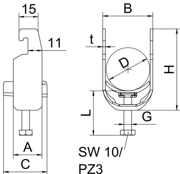
Bügelshelle mit U-Fuß, Kunststoffdruckwanne aus Polypropylen. Zur vertikalen und horizontalen Montage von 1 Einzelkabel an C-Profilshiene. Für Schlitzweite 18 - 22 mm. Mit 1-gängiger Schraube an Druckwanne, universeller Sechskant-Schraubenkopf SW10, mit Schlitz und Kreuzschlitz. Geeignet für Montage im Innen- und Außenbereich. Gegenwanne muss separat bestellt werden.
