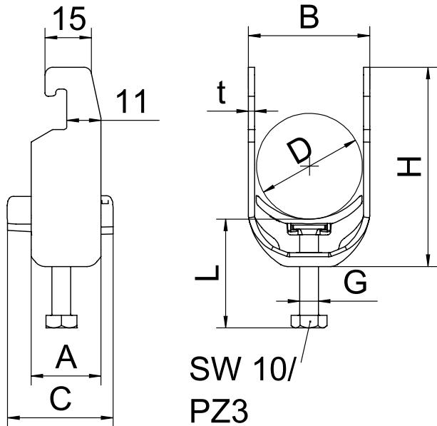
Bügelschelle mit U-Fuß, Kunststoffdruckwanne aus Polypropylen. Zur vertikalen und horizontalen Montage von 1 Einzelkabel an C-Proflschiene. Für Schlitzweite 18 - 22 mm. Mit 1-gängiger Schraube an Druckwanne, universeller Sechskant-Schraubenkopf SW10, mit Schlitz und Kreuzschlitz. Geeignet für Montage im Innen- und Außenbereich. Gegenwanne muss separat bestellt werden.
