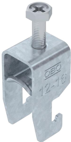
Bügelshelle mit U-Fuß, Metalldruckwanne mit gerundeten Kanten für Kabelschutz. Zur vertikalen und horizontalen Montage von 1 Einzelkabel an C-Profilshiene. Für Schlitzweite 18 - 22 mm. Mit 1-gängiger Schraube an Druckwanne, universeller Sechskant-Schraubenkopf SW10, mit Schlitz und Kreuzschlitz. Geeignet für Montage im Innen- und Außenbereich. Der Einsatz einer Gegenwanne wird empfohlen.
