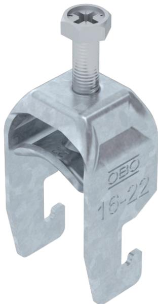
Bügelschelle mit U-Fuß, Metalldruckwanne mit gerundeten Kanten für Kabelschutz. Zur vertikalen und horizontalen Montage von 1 Einzelkabel an C-Profilsschiene. Für Schlitzweite 18 - 22 mm. Mit 1-gängiger Schraube an Druckwanne, universeller Sechskant-Schraubenkopf SW10, mit Schlitz und Kreuzschlitz. Geeignet für Montage im Innen- und Außenbereich. Der Einsatz einer Gegenwanne wird empfohlen.
