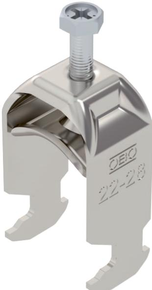
Bride de fixation avec embase à tête de marteau, plaque de pression en métal avec bords arrondis pour la protection des câbles. Pour montage vertical et horizontal d'1 câble individuel sur des rails profilés en C. Pour une ouverture de 16 - 17 mm. Avec vis à 1 filet sur plaque de pression, tête de vis hexagonale universelle SW10, avec fente et empreinte cruciforme. Convient au montage en intérieur et en extérieur. L'utilisation d'une contre-plaque est recommandée.
