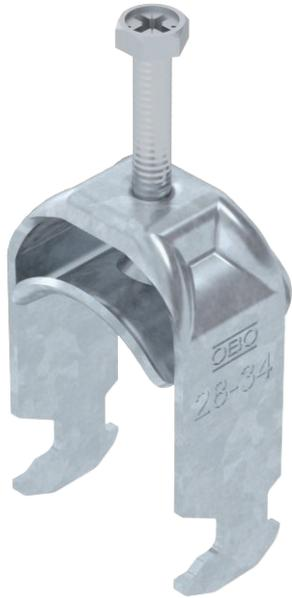
Bride de fixation avec embase à tête de marteau, plaque de pression en métal avec bords arrondis pour la protection des câbles. Pour montage vertical et horizontal d'1 câble individuel sur des rails profilés en C. Pour une ouverture de 16 - 17 mm. Avec vis à 1 filet sur plaque de pression, tête de vis hexagonale universelle SW10, avec fente et empreinte cruciforme. Convient au montage en intérieur et en extérieur. La contre-plaque doit être commandée séparément.
