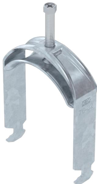
Bride de fixation avec embase à tête de marteau, plaque de pression en métal avec bords arrondis pour la protection des câbles. Pour montage vertical et horizontal d'1 câble individuel sur des rails profilés en C. Pour une ouverture de 16 - 17 mm. Avec vis à 1 filet sur plaque de pression, tête de vis hexagonale universelle SW10, avec fente et empreinte cruciforme. Convient au montage en intérieur et en extérieur. La contre-plaque doit être commandée séparément.
