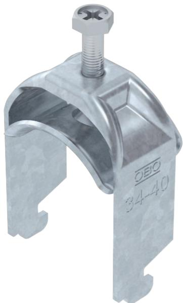
Bride de fixation avec pied N, plaque de pression en métal avec bords arrondis pour la protection des câbles. Pour montage vertical et horizontal d'1 câble individuel sur des rails profilés en C. Pour une ouverture de 11 - 12 mm. Avec vis à 1 filet sur plaque de pression, tête de vis hexagonale universelle SW10, avec fente et empreinte cruciforme. Convient au montage en intérieur et en extérieur. L'utilisation d'une contre-plaque est recommandée.
