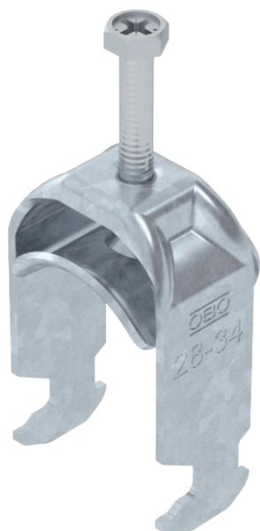
Staffa reggicavo con base a testa di martello, coppa in metallo con bordi arrotondati per la protezione del cavo. Per il montaggio verticale e orizzontale di 1 cavo singolo su profilato a C. Per dimensioni dell'asola di 16 - 17 mm. Con una vite sulla coppa premente, testa della vite esagonale universale da SW10, a taglio e a croce. Per il montaggio in ambienti interni ed esterni. La controcoppa deve essere ordinata separatamente.
