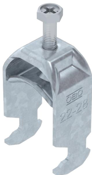
Staffa reggicavo con base a testa di martello, coppa in metallo con bordi arrotondati per la protezione del cavo. Per il montaggio verticale e orizzontale di 1 cavo singolo su profilato a C. Per dimensioni dell'asola di 16 - 17 mm. Con una vite sulla coppa premente, testa della vite esagonale universale da SW10, a taglio e a croce. Per il montaggio in ambienti interni ed esterni. La controcoppa deve essere ordinata separatamente.
