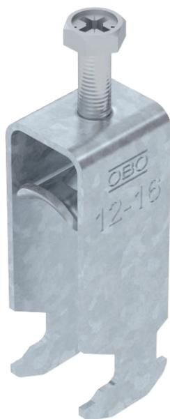
Staffa reggicavo con base a testa di martello, coppa in metallo con bordi arrotondati per la protezione del cavo. Per il montaggio verticale e orizzontale di 2 cavi singoli su profilato a C. Per dimensioni dell'asola di 16 - 17 mm. Con una vite sulla coppa premente, testa della vite esagonale universale da SW10, a taglio e a croce. Per il montaggio in ambienti interni ed esterni. Più cavi dovrebbero essere separati da coppe doppie. Si consiglia di utilizzare una controcoppa.
