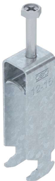
Staffa reggicavo con base a testa di martello, coppa in metallo con bordi arrotondati per la protezione del cavo. Per il montaggio verticale e orizzontale di 3 cavi singoli su profilato a C. Per dimensioni dell'asola di 16 - 17 mm. Con una vite sulla coppa premente, testa della vite esagonale universale da SW10, a taglio e a croce. Per il montaggio in ambienti interni ed esterni. Più cavi dovrebbero essere separati da coppe doppie. Si consiglia di utilizzare una controcoppa.
