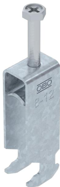
Staffa reggicavo con base a testa di martello, coppa in metallo con bordi arrotondati per la protezione del cavo. Per il montaggio verticale e orizzontale di 3 cavi singoli su profilato a C. Per dimensioni dell'asola di 16 - 17 mm. Con una vite sulla coppa premente, testa della vite esagonale universale da SW10, a taglio e a croce. Per il montaggio in ambienti interni ed esterni. Più cavi dovrebbero essere separati da coppe doppie. Si consiglia di utilizzare una controcoppa.
