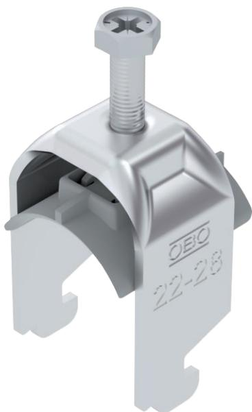
Staffa reggicavo con base a N, coppa in plastica di polipropilene. Per il montaggio verticale e orizzontale di 1 cavo singolo su profilato a C. Per dimensioni dell'asola di 11 - 12 mm. Con una vite sulla coppa premente, testa della vite esagonale universale da SW10, a taglio e a croce. Per il montaggio in ambienti interni ed esterni. Si consiglia di utilizzare una controcoppa.
