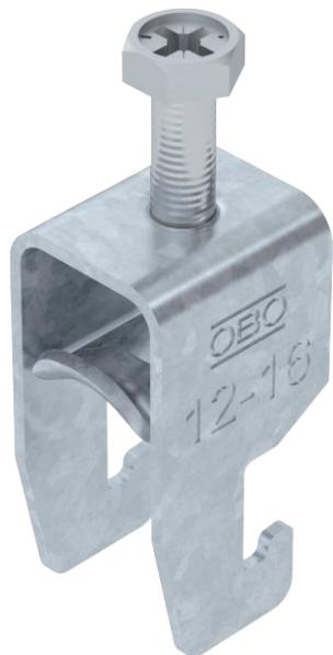
Staffa reggicavo con base a U, coppa in metallo con bordi arrotondati per proteggere il cavo. Per il montaggio verticale e orizzontale di 1 cavo singolo su profilato a C. Per dimensioni dell'asola di 18 - 22 mm. Con una vite sulla coppa premente, testa della vite esagonale universale da SW10, a taglio e a croce. Per il montaggio in ambienti interni ed esterni. Si consiglia di utilizzare una controcoppa.
