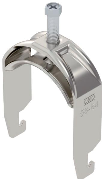
Staffa reggicavo con base a U, coppa in metallo con bordi arrotondati per proteggere il cavo. Per il montaggio verticale e orizzontale di 1 cavo singolo su profilato a C. Per dimensioni dell'asola di 18 - 22 mm. Con una vite sulla coppa premente, testa della vite esagonale universale da SW10, a taglio e a croce. Per il montaggio in ambienti interni ed esterni. Si consiglia di utilizzare una controcoppa.
