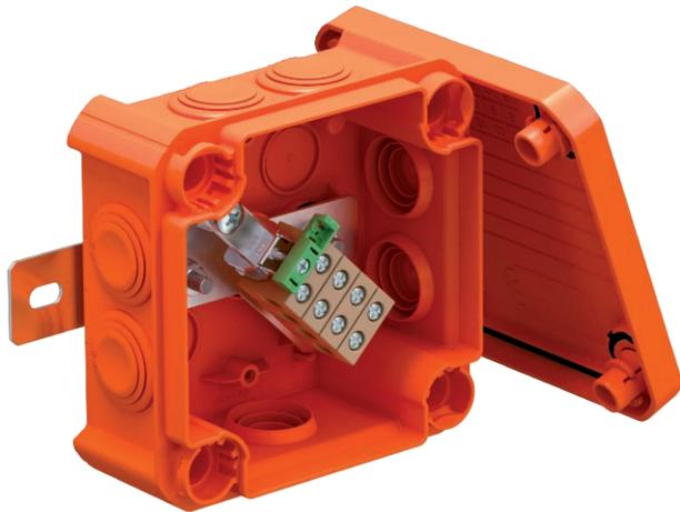
Kabelabzweigkasten mit keramischen Einzelklemmen und weichen Einsteckdichtungen. Ausreichender Verdrahtungsraum durch diagonal angeordnete Anschlusseinheit mit komplett vormontierten hochtemperaturbeständigen Keramikklemmen. Grün-Gelb gekennzeichnete Schutzleiterklemme. Befestigung an gut zugänglichen Außenlaschen. Zugelassen für Kabelanlagen mit elektrischem Funktionserhalt nach DIN 4102 Teil 12 mit den Klassen E30, E60 und E90. Keramikklemmen wurden nach DIN EN 60998-2-1:2004 geprüft.
