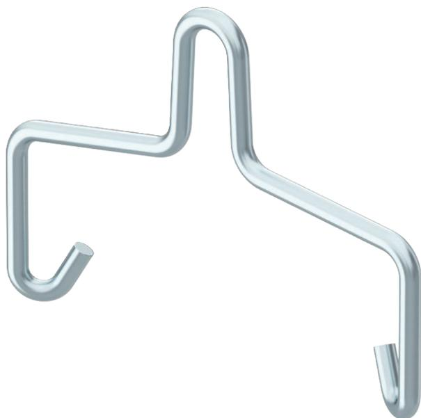
Étrier de suspension pour la fixation du câble tendeur en fils d'acier ou de la chaîne du rail support pour luminaires type LTS 100 et du canal AZ type AZK 100.
