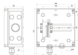
Gehäuseanschlusskasten für E-Mobility.
