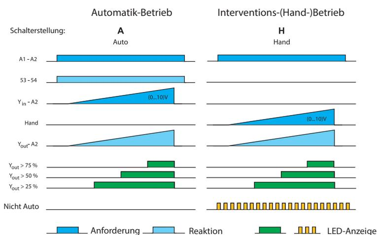
53-54 Rückmeldung an die Steuerung für im "Automatik-Betrieb"
