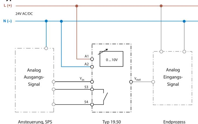
In der Stellung A (Auto), des mit A und H gekennzeichneten Schalters, wird das Analog-Signal aus der Ansteuerung von Y<sub>in</sub> - A2 nach Y<sub>out</sub> geleitet. In der Stellung H (Hand) wird das, am mit % gekennzeichnete Poti eingestellte Signal (0...10)V DC über Y<sub>out</sub> als Soll-Wert bereit gestellt.
