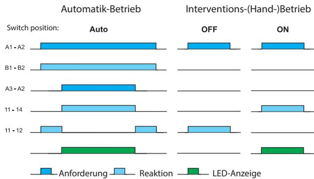
B1-B2 Rückmeldung an die Steuerung für "Im Automatik-Betrieb"
