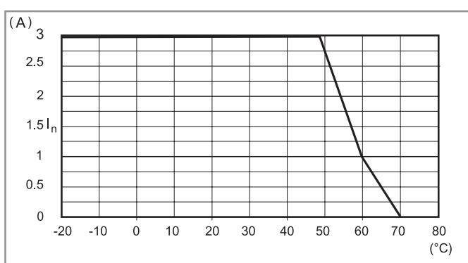
L78-3 Courant de sortie en fonction de la température ambiante (78.36) 12 V
