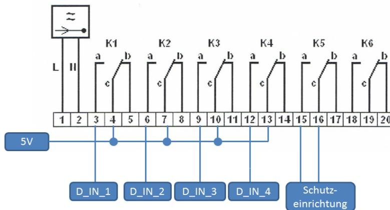
Abb.: Verkabelung Rundsteuerempfänger mit 5 Relais - Beispiel 4
