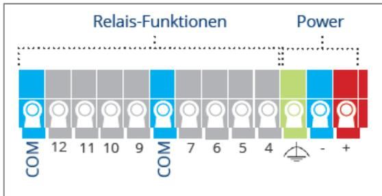
Abb.: PIN-Belegung an der Oberseite
