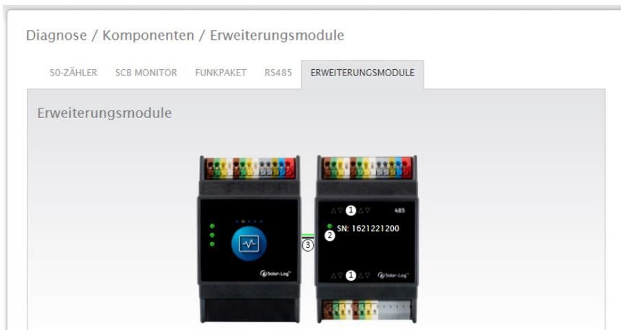
Abb.: Solar-Log™ MOD 485 - Solar-Log™ Base Kommunikationsbus/LEDs
