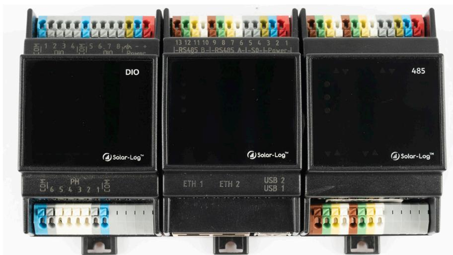
Abb.: Kombination Solar-Log™ Base mit Solar-Log™ MOD I/O und Solar-Log™ MOD 485 (Verbunden - Vorderseite)
