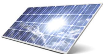
**Panneau solaire** – Les cellules sont laminées durablement entre une feuille et le verre sous vide et par une forte chaleur. Le brasage de bandes de cuivre permet ensuite de connecter plusieurs cellules solaires en série. Après le laminage, les tranches sont bordées, les boîtes de raccordement installées et équipées de diodes de roue libre. Un cadre en aluminium assure la stabilité du panneau.
