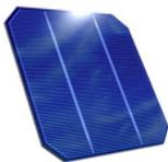
**Cellule photovoltaïque** – Une cellule photovoltaïque est construite en deux couches de charges différentes. Pour créer cette différence de charge, différents types d'atomes étrangers sont intégrés de manière ciblée dans la couche supérieure et inférieure. Ensuite, la cellule est généralement recouverte d'une couche antireflet bleutée. Ensuite, les contacts métalliques sont alors placés au recto et au verso.
