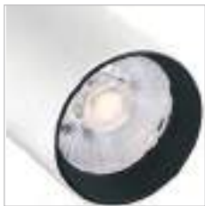
Professionelle Linsenoptik für optimale Farbhomogenität; Reduzierte Blendung (UGR 16 bei 23°; UGR 18 bei 36°) durch schwarzen Entblendungsring
