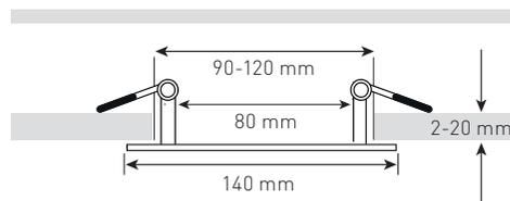
Convient aux spots d'un diamètre extérieur de 100 mm max.
