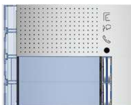
Frontblende für Ruftasten- und Türlautsprecher-Modul Legrand Bticino Sfera New, Allmetal, Tasten vertikal, IP 54, IK 08, 115 × 91 mm, 2 Drucktaster, aluminium
