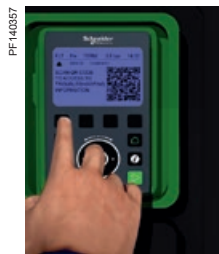
Bei Fehlererkennung erzeugte integrierte dynamische QR-Codes
