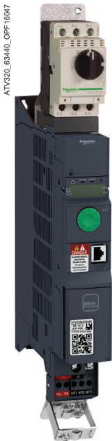
Montage direct GV2/ATV320 : GV2L08 + (VW3A9921 + GV2AF5) (5) (6) + ATV320U07N4B
